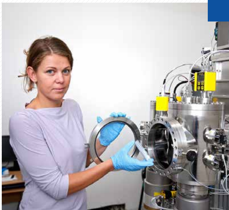
Unikátní pětikomorové naprašovací zařízení pro vývoj tenkovrstvých solárních článků PECVD.
