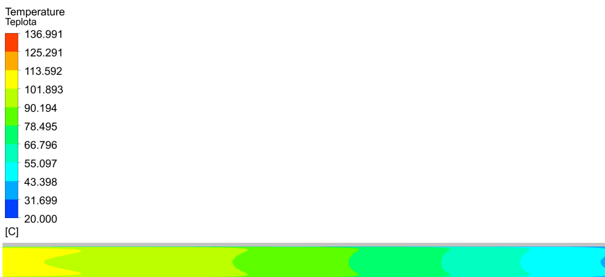
Obrázek 11: Numerická simulace pro případ najíždění vysokotlaké regenerace v čase 26 s – Varianta 120 °C, 5 kg/s
