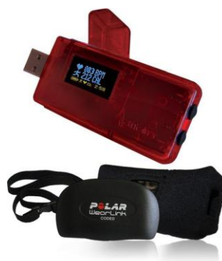
Obrázek 3 Akcelerometr ActiTrainer s příslušeností a monitorem tepové frekvence značky Polar
