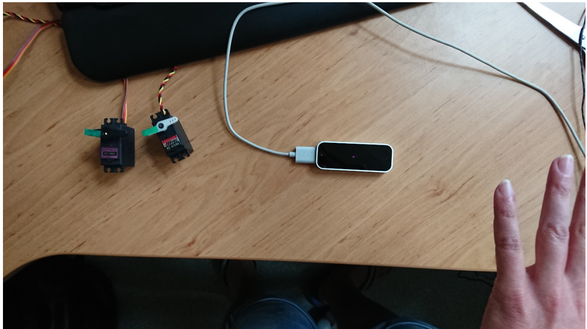
Obr. 6 Pozice ruky -200, -200, obě serva jsou v nule
