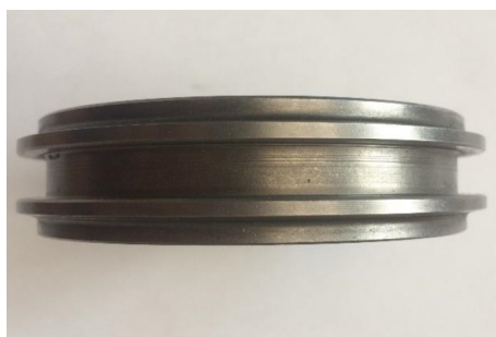
Obr. 2 Řadicí objímka s obvodovou drážkou [2]
