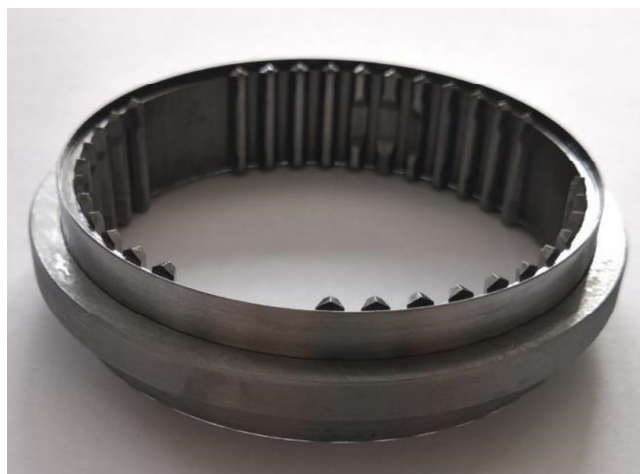
Obr. 8 Přípravek pro lepení osoustružené řadicí objímky a kroužku (vlevo) a prototyp řadicí objímky s výstupkem [2]
