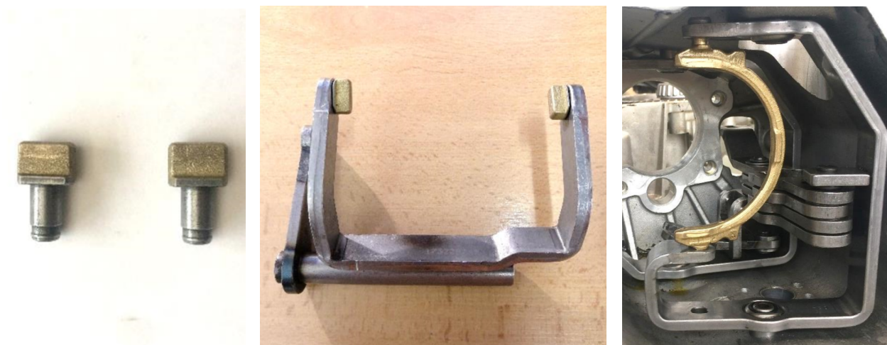
Obr. 3 Otočné řadicí kameny (vlevo), sestava řadicí vidličky s řadicími kameny (uprostřed) a půlměsícový řadicí kamen s trojbodovým stykem (vpravo) [2]
