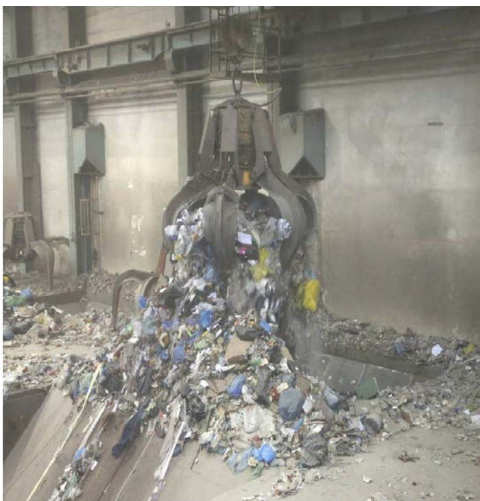
Obr. 11. Jeřáb přesouvá odpad do kotle [48]
