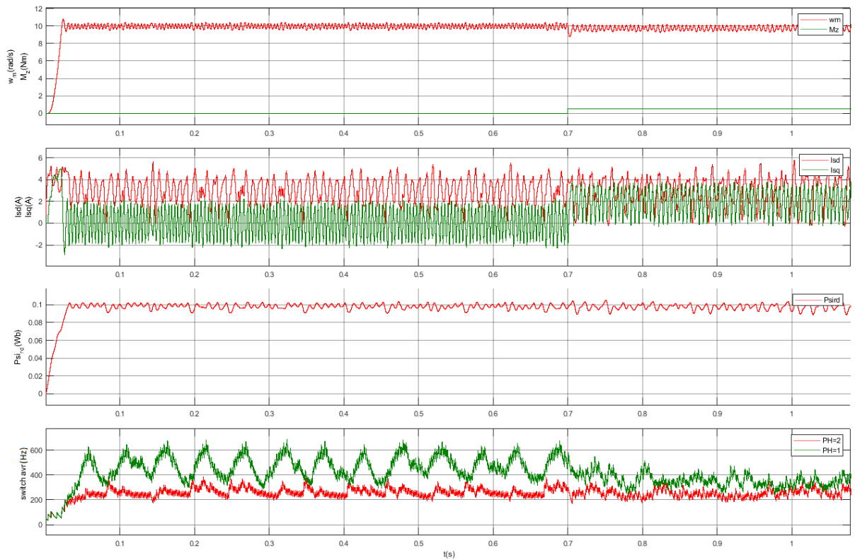
Obrázek 3.9: Průběh otáček \omega_m , satorových proudů I_{sd} , i_{sq} , magnetického toku rotoru \Psi_{rd} a průměrné změny spínání switch avr
