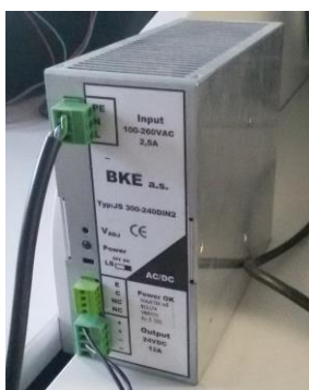
Obr. 3.6: Napájecí zdroj záznamové jednotky – spínaný zdroj stejnosměrných 24 V
