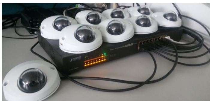
Obr. 3.3: Zapojení IP kamer Axis P3904-R MK II do PoE switche
