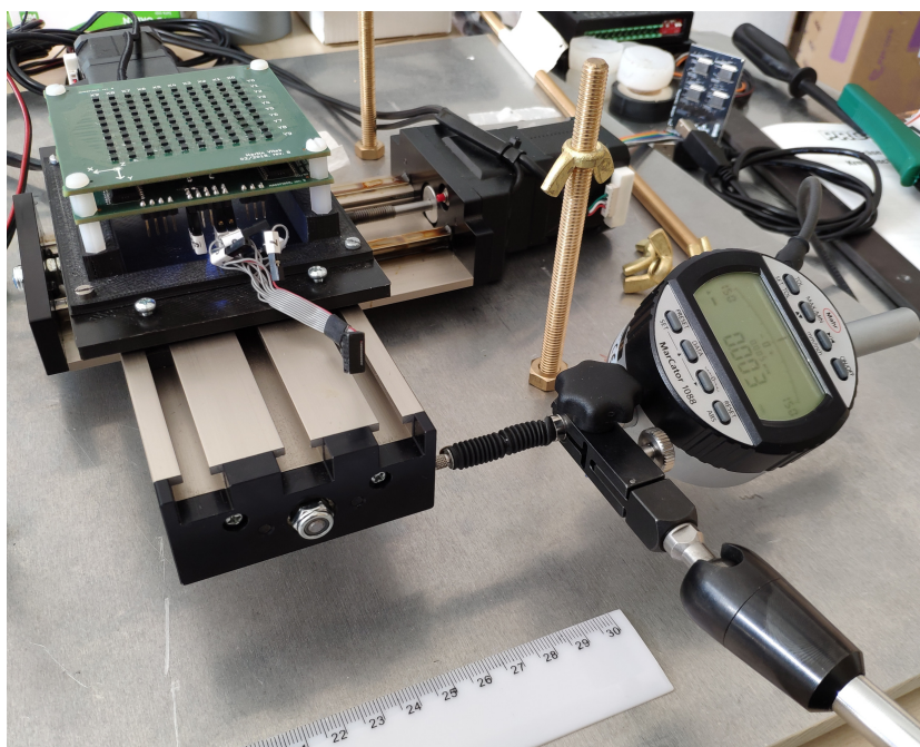
Obr. 42: Měření kroku a vůle křížového stolu pomocí úchylkoměru.
