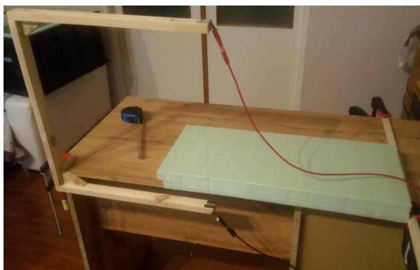
Obr. 21: Úprava polystyrenu pomocí odporového drátu (zdroj vlastní)
