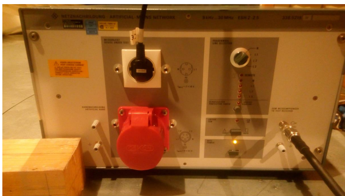
Obr. 58: Umělá síť pro měření rušení po vedení (zdroj vlastní)
