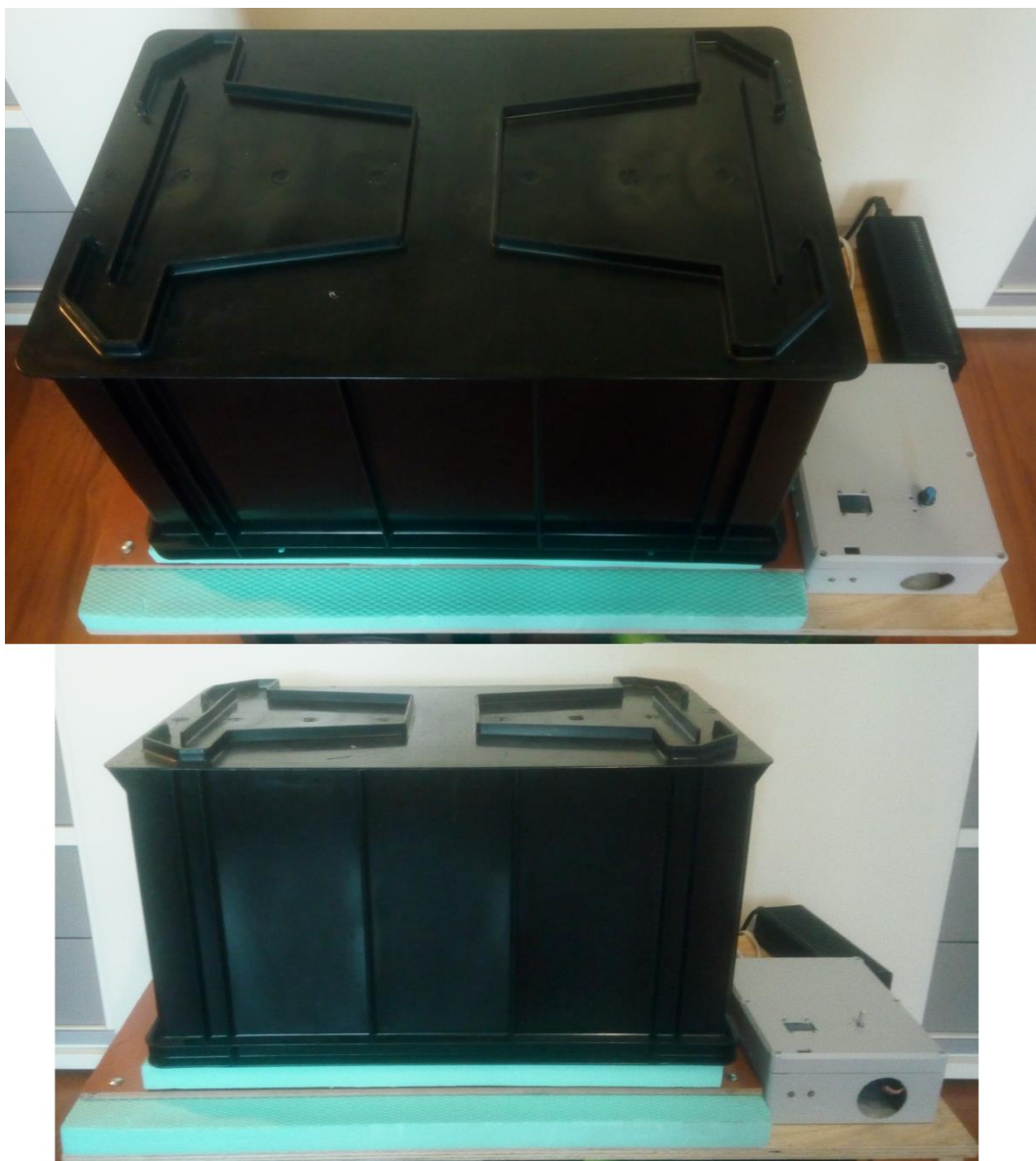
Obr. 68: Provedení tepelného boxu 2 (zdroj vlastní)
