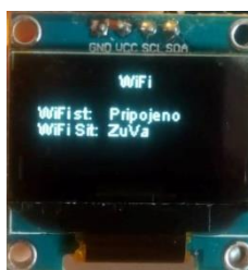
Obr. 43: Obrazovka info Wi-Fi (zdroj vlastní)
