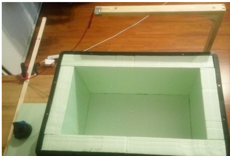
Obr. 22: Zateplení tepelného boxu (zdroj vlastní)
