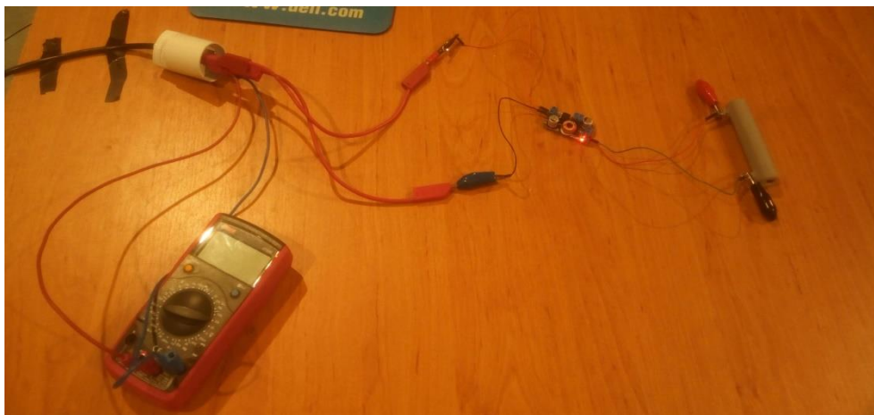
Obr. 27 : Měření rušení po vedení 150kHz - 30MHz (zdroj vlastní)
