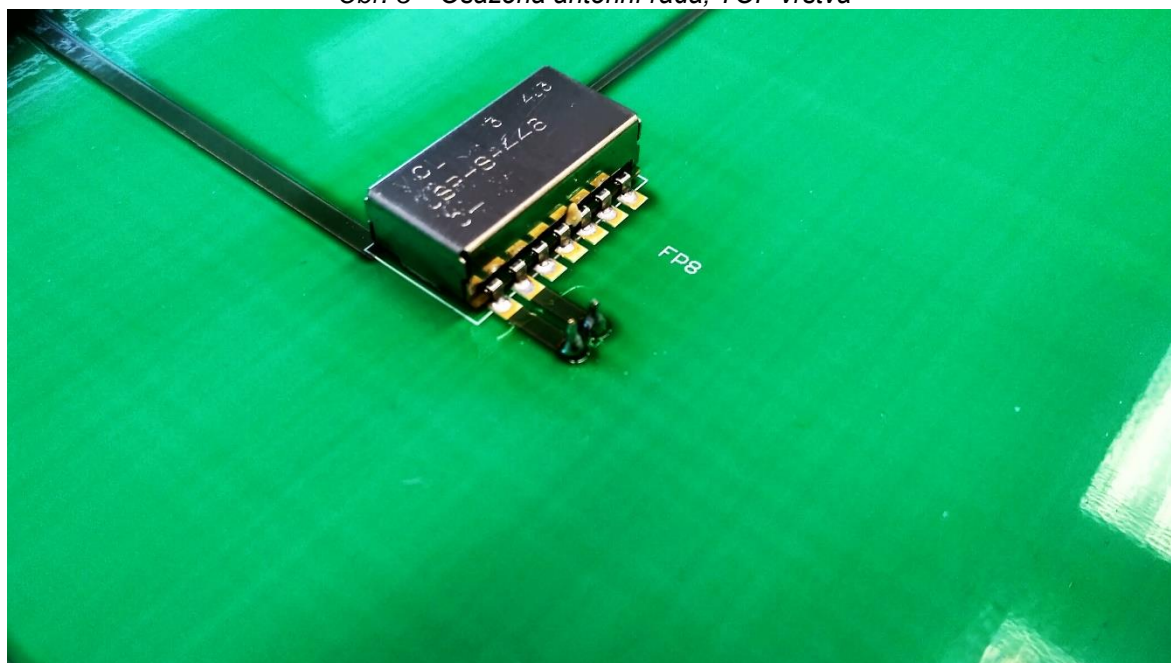
Obr. 4 – Detail zapájení fázového posouvače a dvou pinového konektoru
