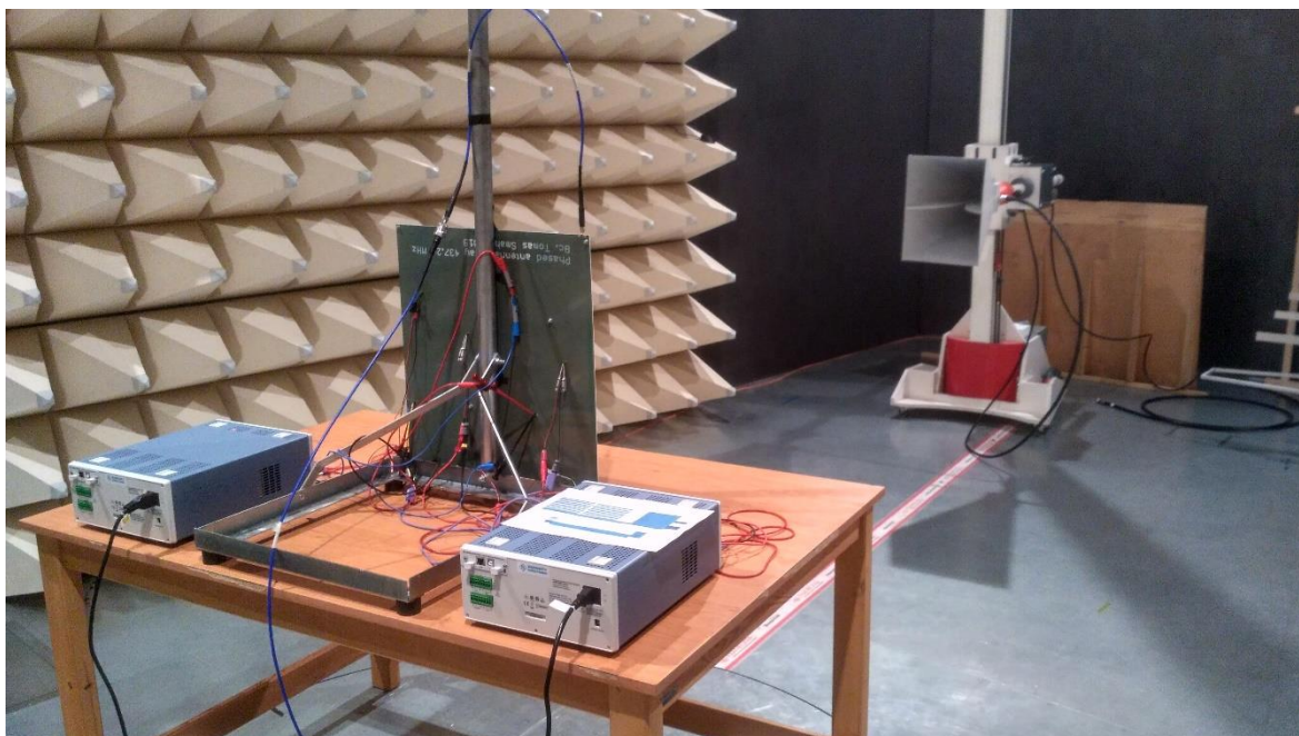
Obr. 9 – Měření anténní řady, bezodrazová komora
