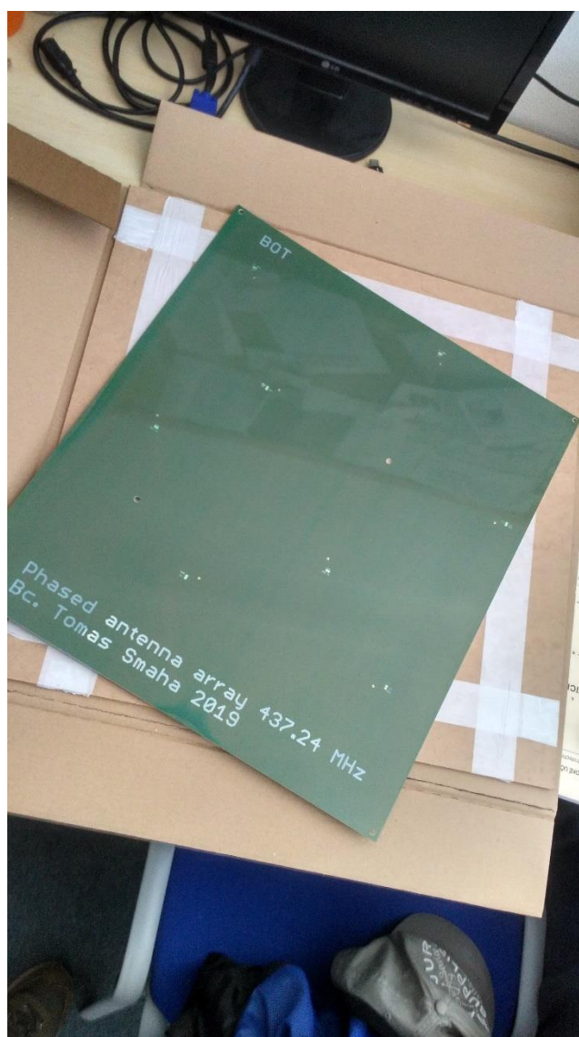
Obr. 2 – Vyrobená anténní řada, BOT vrstva
