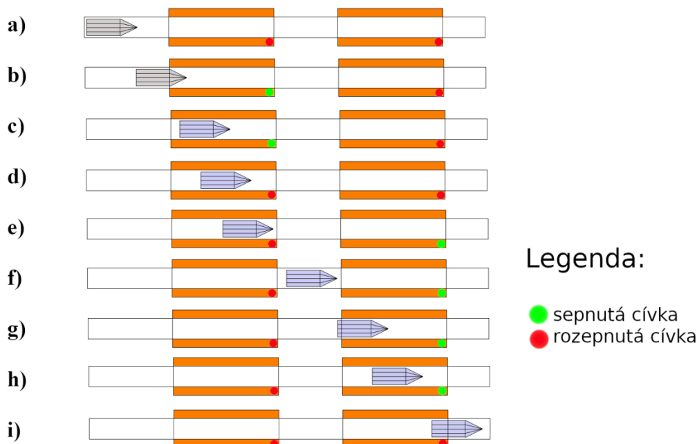
Obrázek 11: Sekvence spínání jednotlivých stupňů magnetického děla
