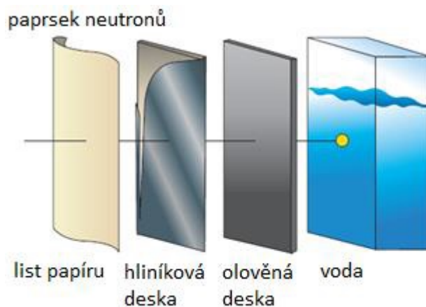
Obrázek 10: Zastavení neutronového záření pomocí vody (převzato z [4])
