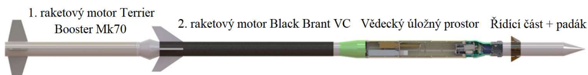
Obr.1: Složení rakety Black Brand IX - převzato ze zdroje [3]
