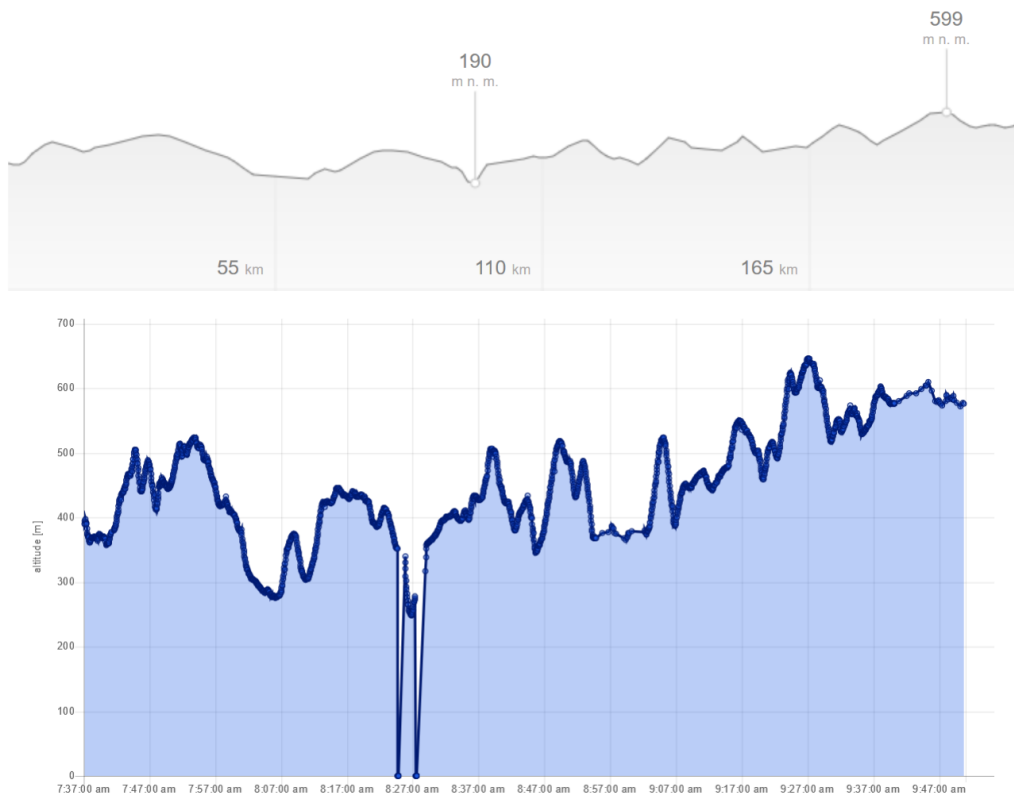
Obrázek 10.2: Výškový profil při cestě z Plzně do Pelhřimova. Horní graf zobrazuje výškový profil získaný z portálu mapy.cz . Spodní graf zobrazuje nadmořskou výšku získanou z vytvořeného systému. Chybějící hodnoty jsou způsobeny jízdou v tunelu.
