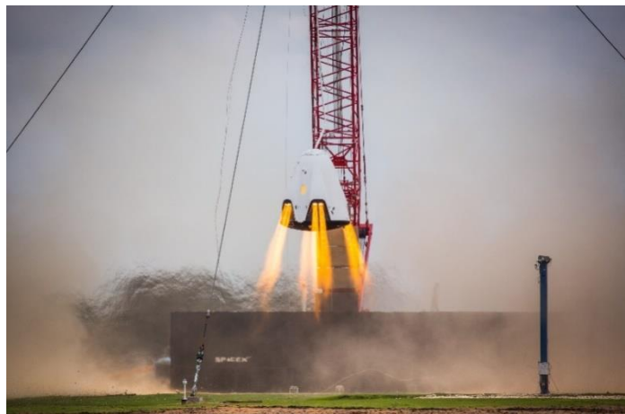
Obrázek 24: Test motorů SuperDraco . [113]
