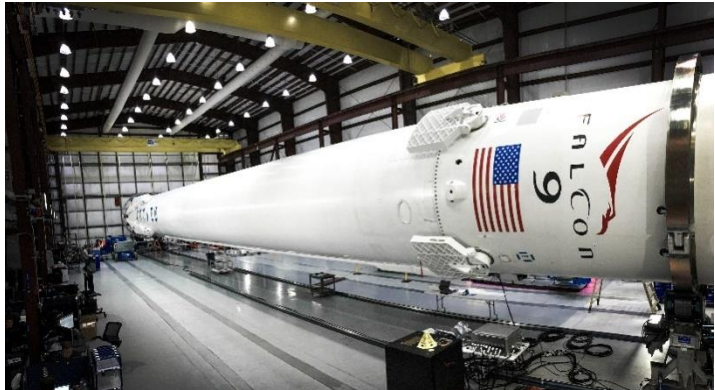
Obrázek 17: První Falcon 9 v1.2 během přípravy mise Orbcomm-2. Na snímku je první stupeň s roštovými kormidly. [110]
