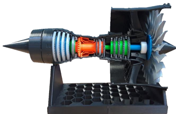
Obrázek 60: 3D model dvou Proudého (turbo ventilátorového) leteckého motoru vyrobený pomocí 3D tiskárny. [autor]
