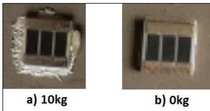
Obrázek 24 – Rozdíl po sintrování se závažím a bez závaží. Na obrázku a) byl vzorek zatížen 10 kg a na obrázku b) nebyl vzorek zatížen.
