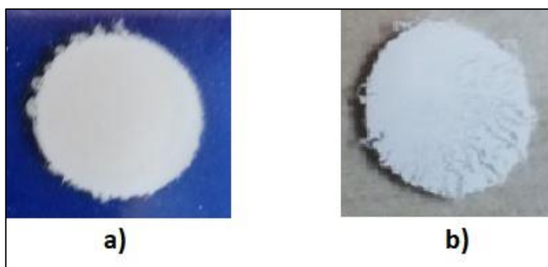
Obrázek 22 – Zkušební vzorky s odplyňovacími kanálky. Obr. a) pasta před sintrováním, obr. b) pasta po sintrování.
