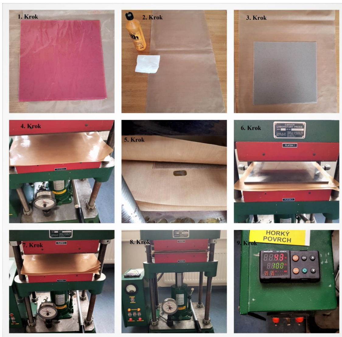
Obr.3.1 Postup přípravy vzorků desky
