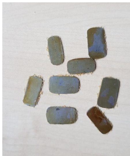
Obr.3.3 Vyteklá pryskyřice na teflonové fólii (vlevo) a distanční plíšky se zbytky pryskyřice (vpravo)
