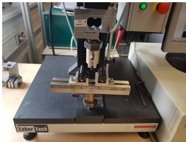
Obr.3.8 Trhací stroj LaborTech připravený pro zkoušku třibodovým ohybem
