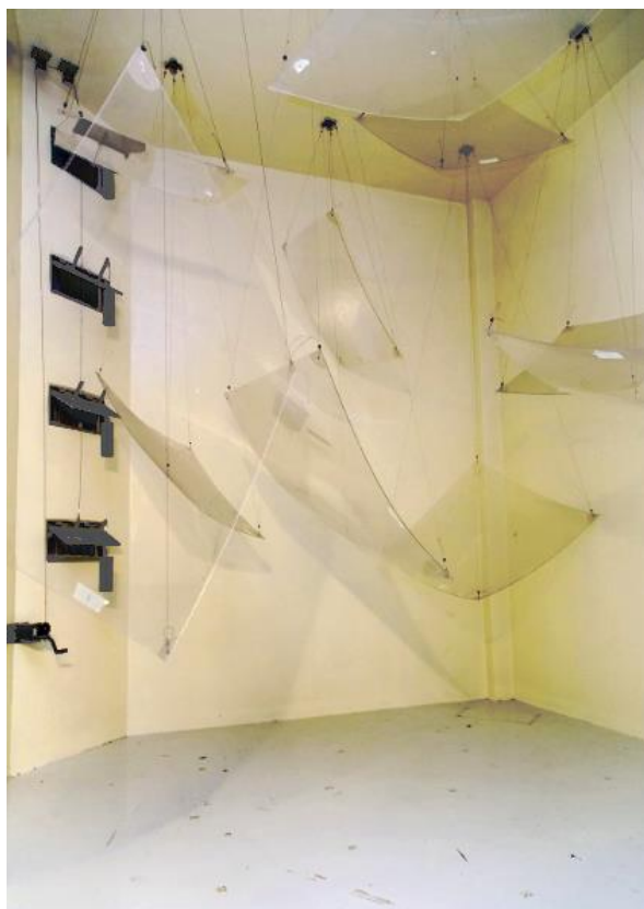
Obr. 1.: Akustická laboratoř - dozvuková komora FEL ZČU (převzato z [1]).
