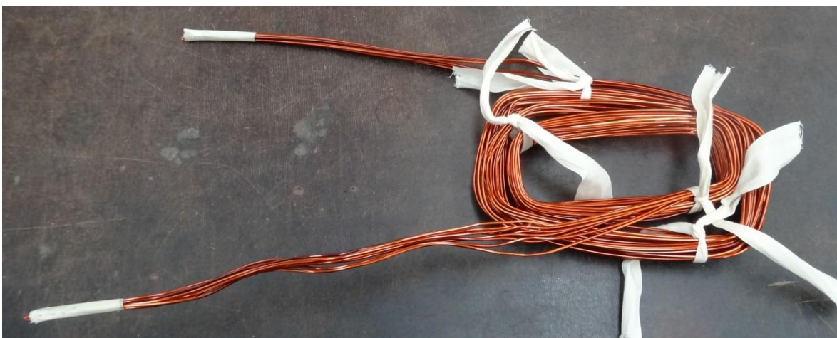
Obr. 3.2.6 Navinutá část vinutí připravená pro navinutí do satoru budiče
