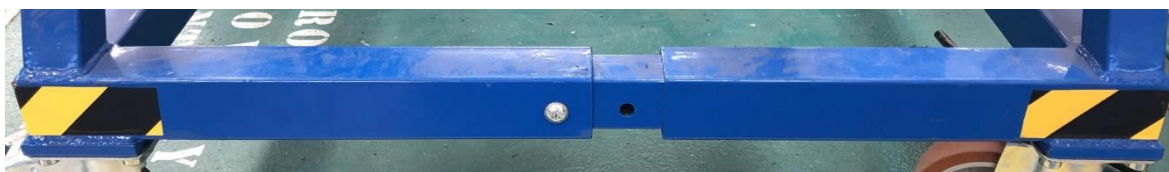
Obr. 3.1.2.2 Druhé řešení - Detail nastavitelné šířky vozíku
