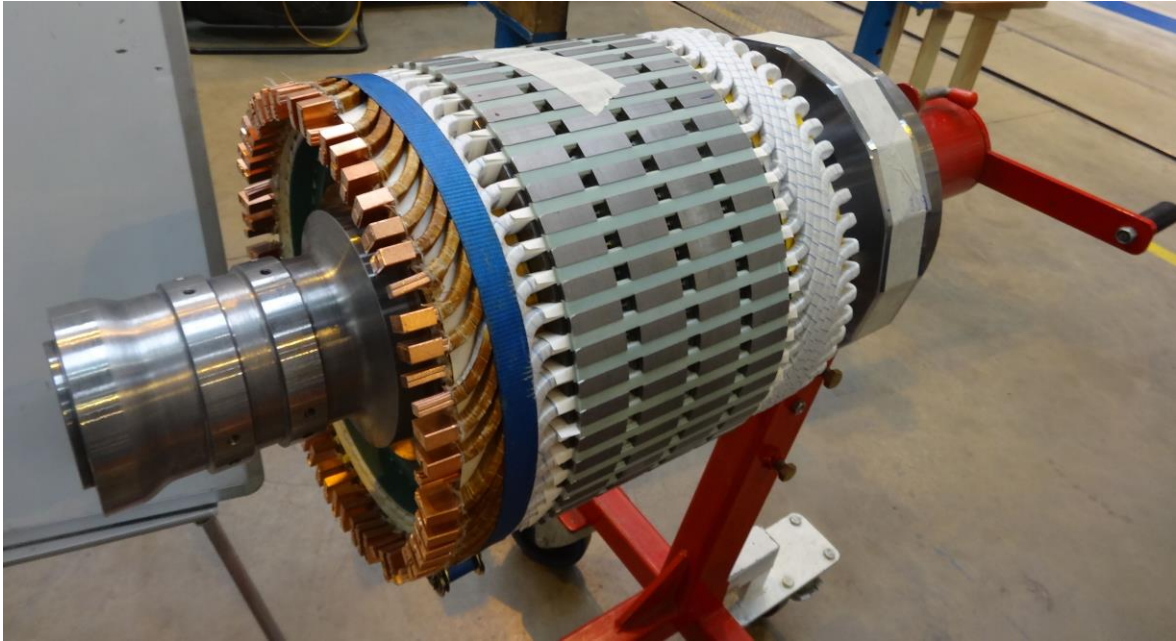
Obr. 3.2.4 Rolna s nasazeným rotorem
