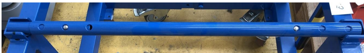
Obr. 3.1.2.3 Druhé řešení - Detail nastavitelné šířky tyče
