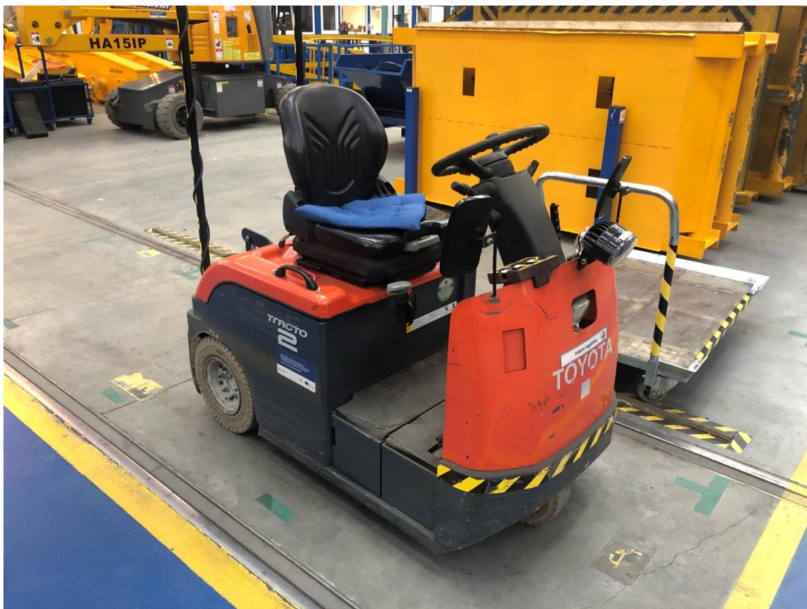
Obr. 3.1.4.3 Druhé řešení - elektrický tahač se sedícím řidičem
