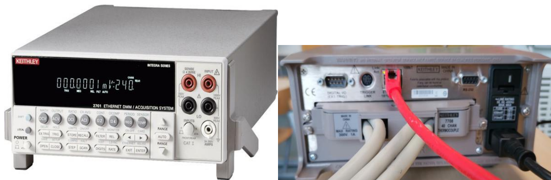
Obr. 11: DMM Keithley 2701 (vlevo), Pohled zezadu na DMM s nainstalovanou multiplexní kartou 7708 (vpravo). (převzato z [23])
