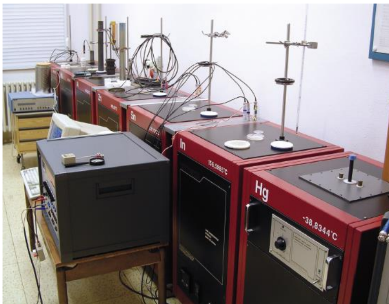
Obr. 1: Sestava pevných bodů realizované teplotní stupnice ITS-90 v laboratoři termometrie ČMI, Praha (3, s. 35).
