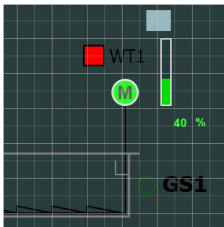
Obr. 49: Indikován High High alarm (přetížení na ochraně WT1)
