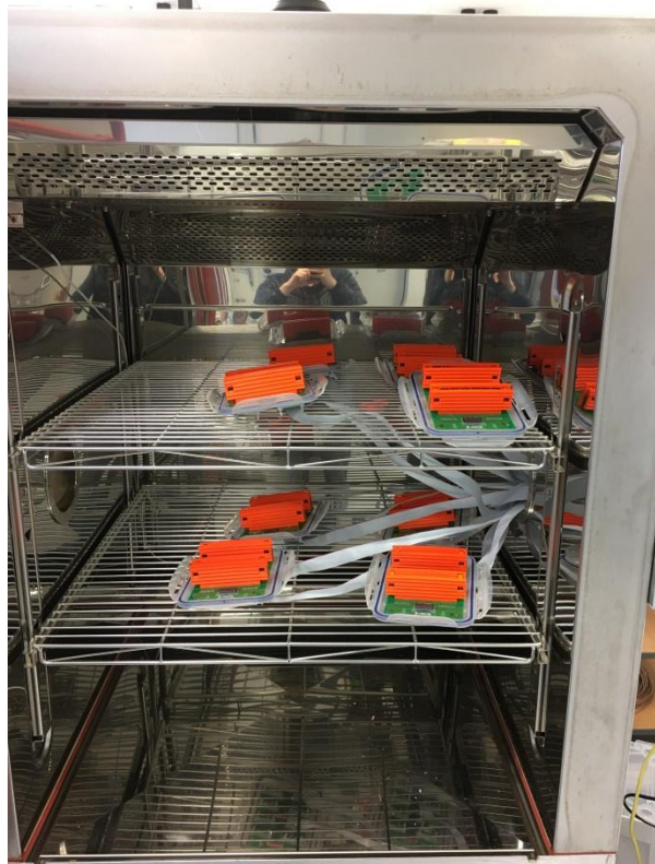
Obr.5.1 Ukázka testování jednotlivých vzorků termistorů při přibližné ref. teplotě 25 °C
