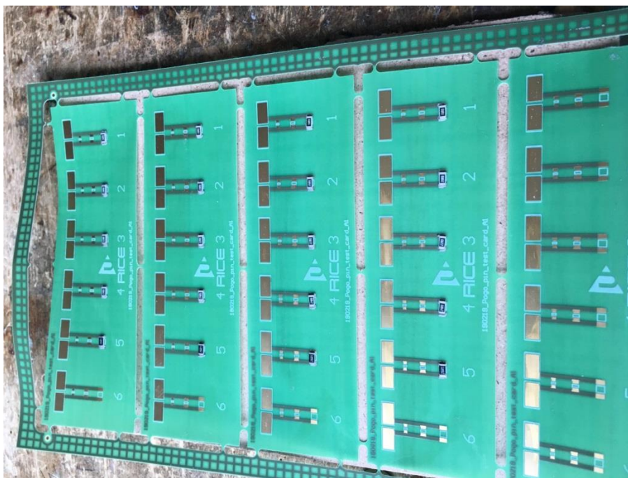
Obr.4.13 Zkušební flexibilní desky pro testování funkčnosti měřicí sestavy
