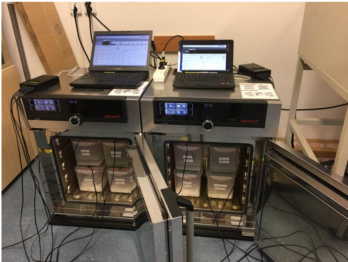
Obr.4.18 Měřicí sestava pro monitorování prostředí v enviroboxech
