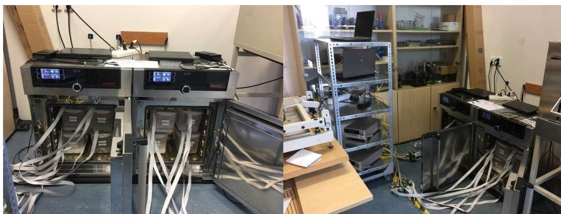
Obr.5.4 Sestava pro měření dlouhodobé stability termistorů
