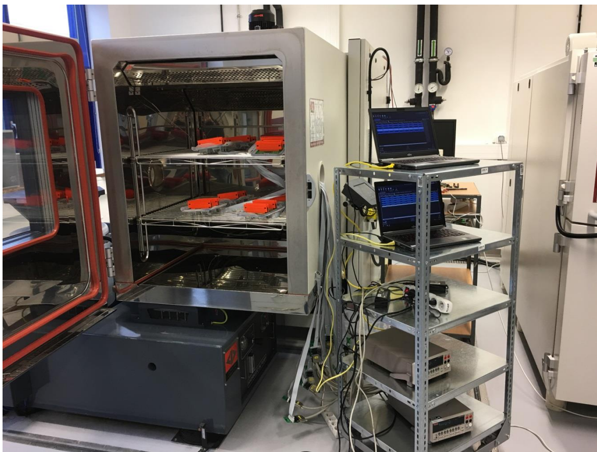
Obr.5.2 Sestavený testovací aparát pro měření kalibračních křivek v klimakomoře
