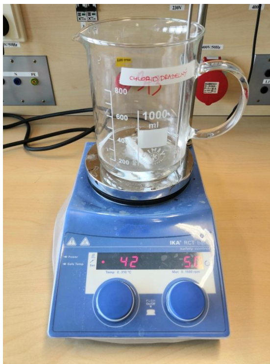
Obr. 4.17 Názorná ukázka míchání roztoku chloridu draselného (KCl)
