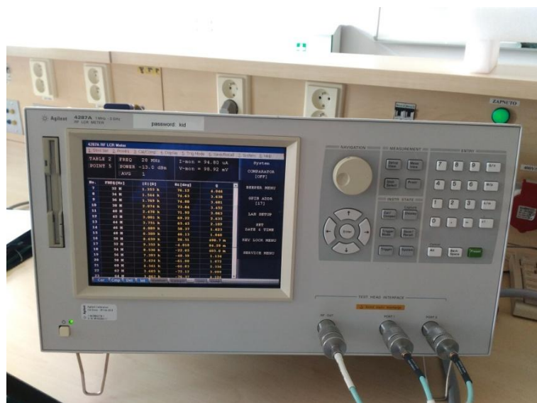
Obr. 3.3 RLC můstek AGILENT 4287.
