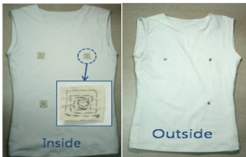
Obr. 1.11 Tričko pro měření EKG s vyšívánými elektrodami. [21]
