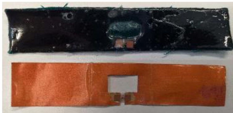
Obr. 1.12 RFID štítek potřený vodivou barvou (nahore) a vystřižený štítek z měděné tkaniny (dole) potažený ochranným lakem. [22]
