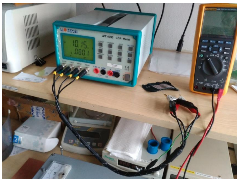
Obr. 3.1 RLC můstek MOTECH MT 4090 s připojeným vzorkem typu E při měření paralelní kapacity.
