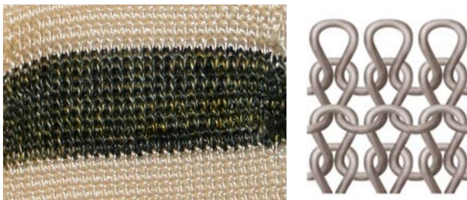
Obr. 1.6 Použití technologie pletení při implementaci v chytrých textiliích (vlevo), struktura pletené textilie (vpravo). [8]
