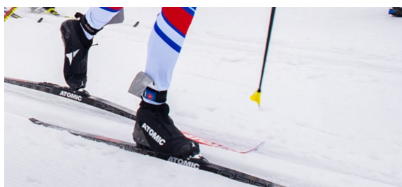
Obr. 1: Čipy na kotnících závodníka [12].
