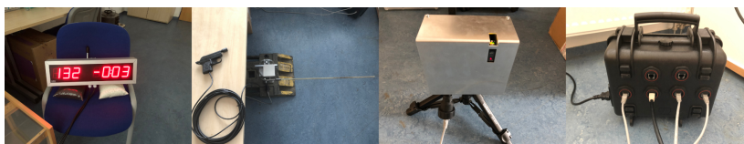
Obr. 23: Části časoměřičského systému použité pro testování, zleva: zobrazovací LED panel, startovní mechanismus, cílový mechanismus, kufr s elektronikou.
