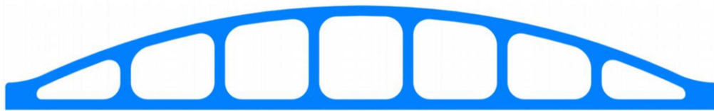
Obrázek 3 - Obloukový Vierendeelův nosník
