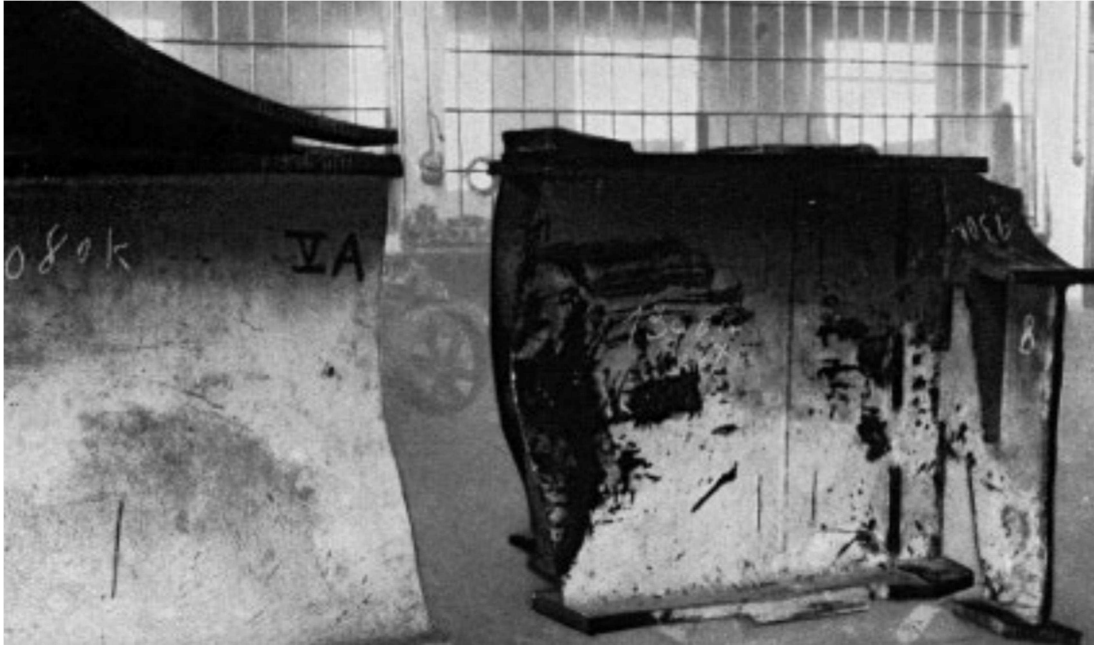
Obrázek 10 - Fragментy spodní pásnice v místě porušení, 1939
