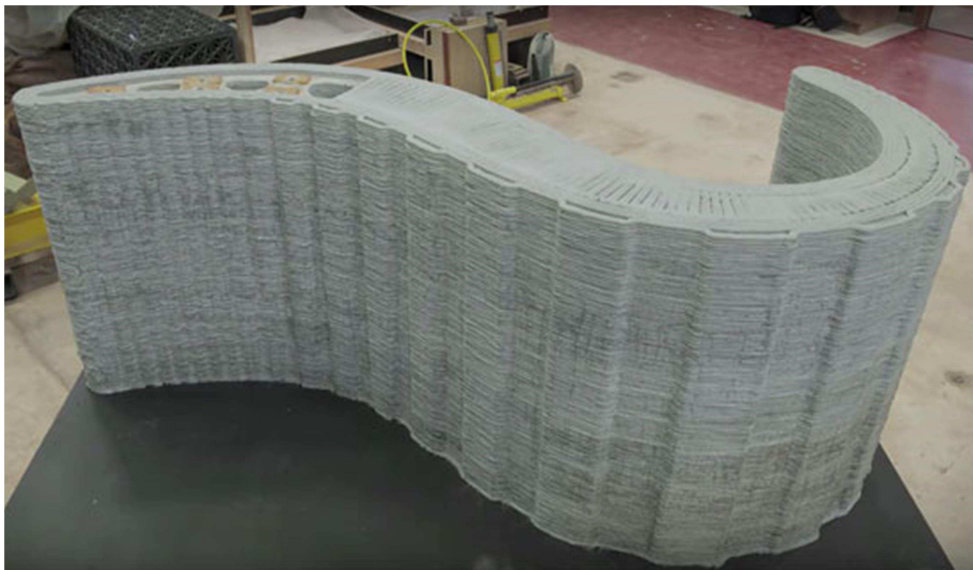
Obrázek 26 - Segment vytištěný pomocí technologie Concrete printing
