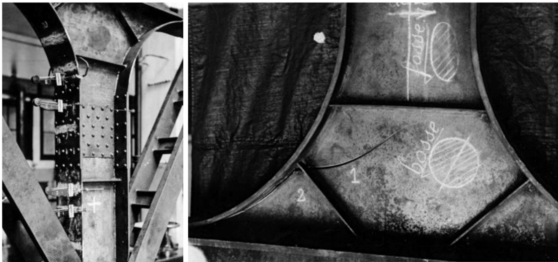
Obrázek 9 – Vlevo: Model styčnicku mostu Schooten připraveného pro vysokocyklický stress test, 1934, Vpravo: Trhlina po 6 milionech cyklů zatížení, 1938
