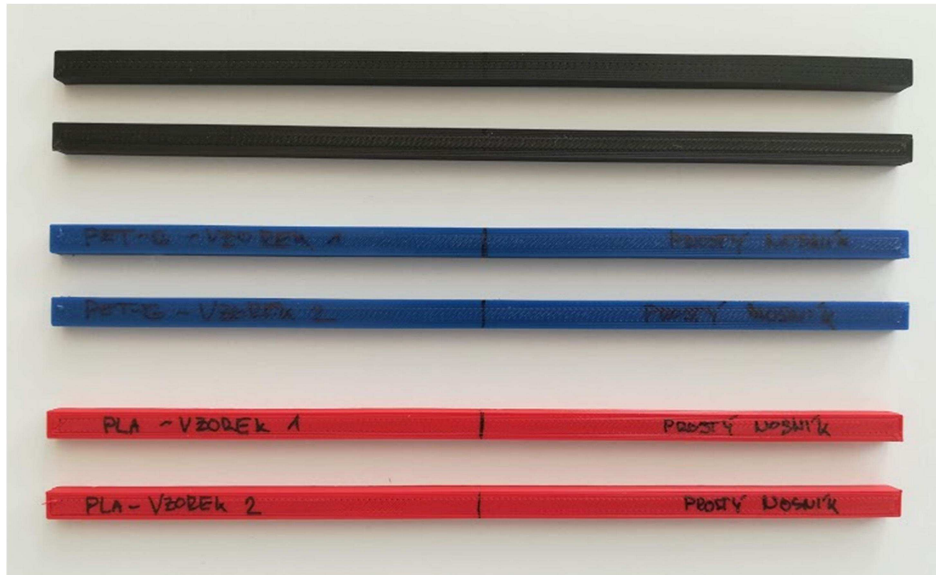
Obrázek 58 - Vytisknuté vzorky prostých nosníků (černá – ABS, modrá - PET-G, červená - PLA) vč. Nastavení
