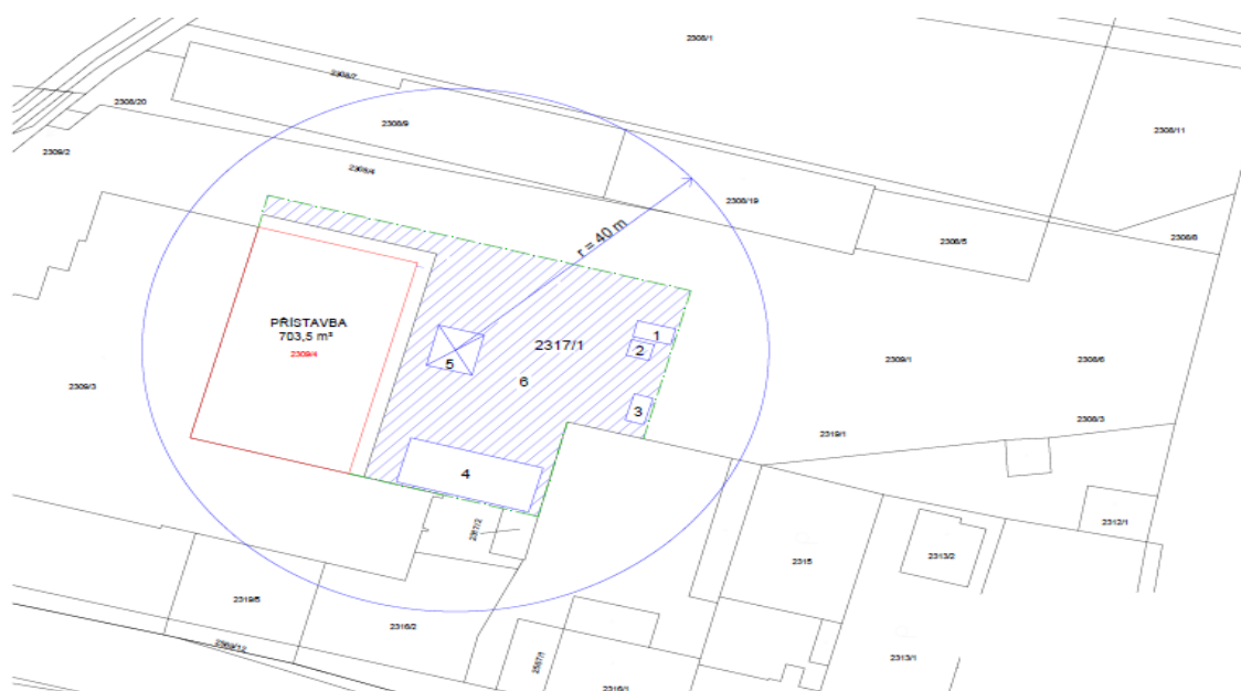
Obrázek 11: Ukázka zařízení staveniště přístavby Invelt [Obrázek: Autorka textu]
