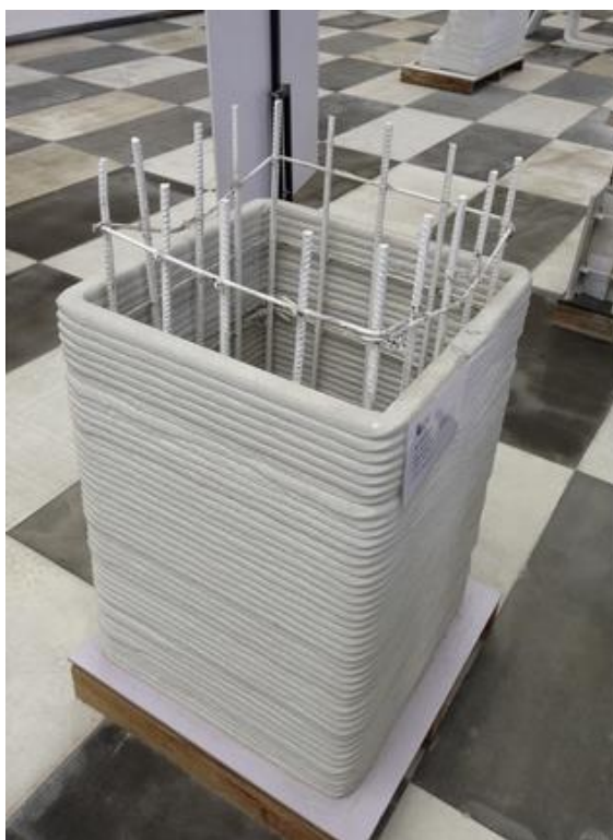
Obrázek 4: Ukázka sloupu tištěného vytlačováním cementové malty, Čína [12]
