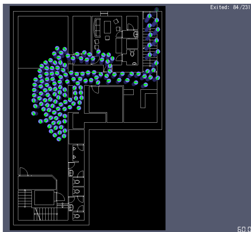
Obrázek č. 27 - Rozmístění návštěvníků v prvním podzemním podlaží klubu č. 4 po šedesáti sekundách od spuštění simulace [Zdroj: autorka diplomové práce]
