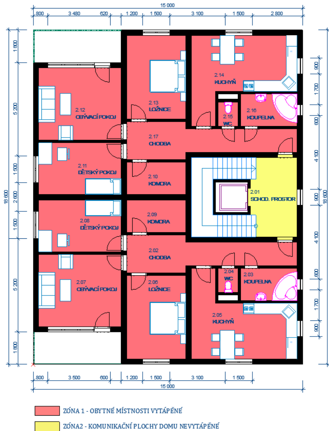
Obrázek 35 Rozdělení objektu na zóny
