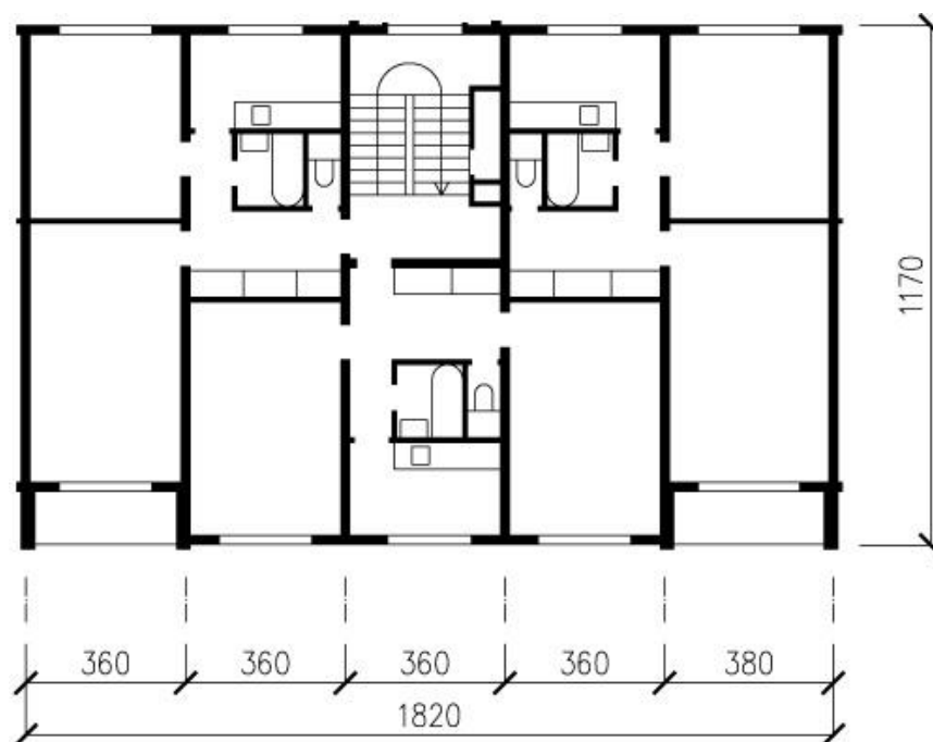
Obrázek 1 – Schéma půdorysu panelové soustavy G 57 [4]
