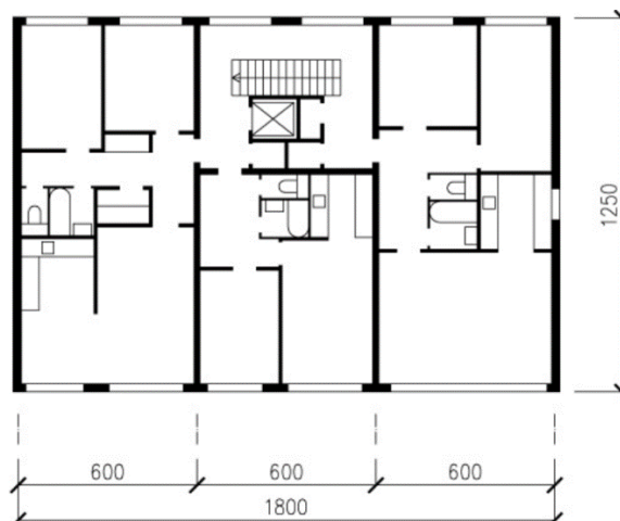
Obrázek 3 - Schéma půdorysu panelové soustavy T 08 B [4]
