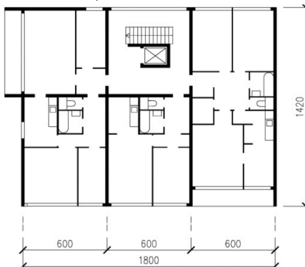
Obrázek 5 - Schéma půdorysu panelové soustavy VVÚ-ETA [4]
