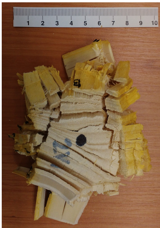
Obrázek 55 – Typické porušení vzorků namáhaných ve směru vláken [autor]
