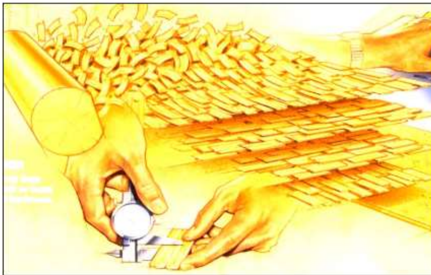
Obrázek 8 – Způsob výroby OSB desek [20]
