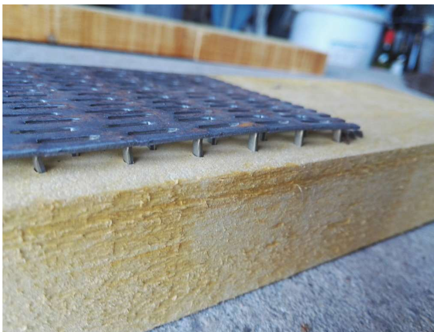
Obrázek 43 – Zvlnění styčnickové desky [autor]
