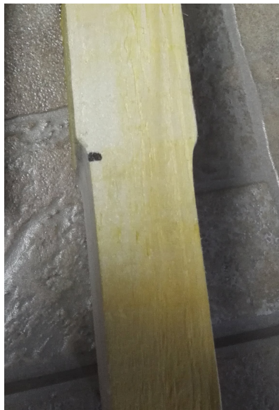
Obrázek 44 – Zúžení vzorku pro upnutí do trhacího stroje [autor]
