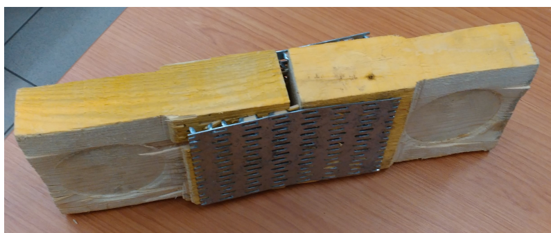
Obrázek 46 – Porušený vzorek RM2 [autor]
