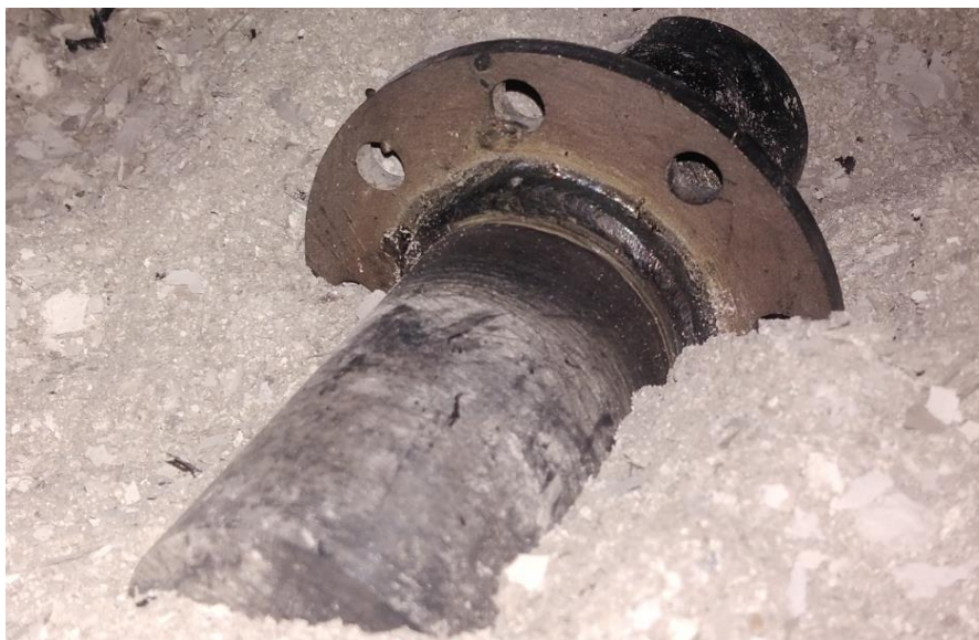
Obr. 34 - Svařenec hřídele chlazení v popelu
