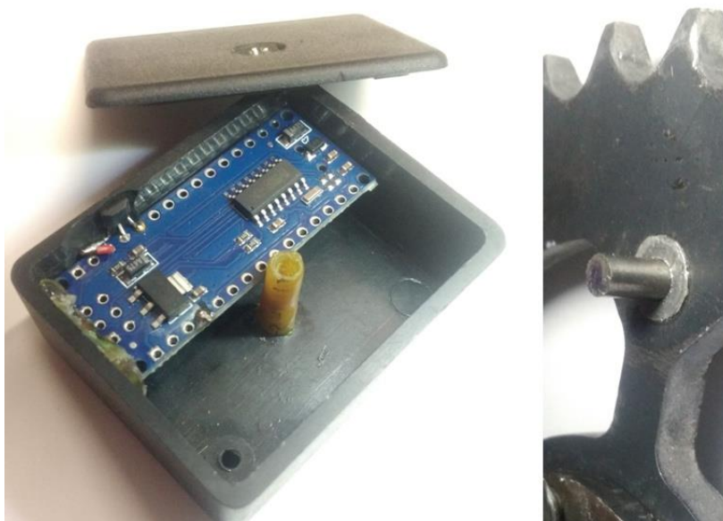
Obr. 45 - Arduino Nano osazené Hallovou sondou a odrušovacím kondenzátorem
