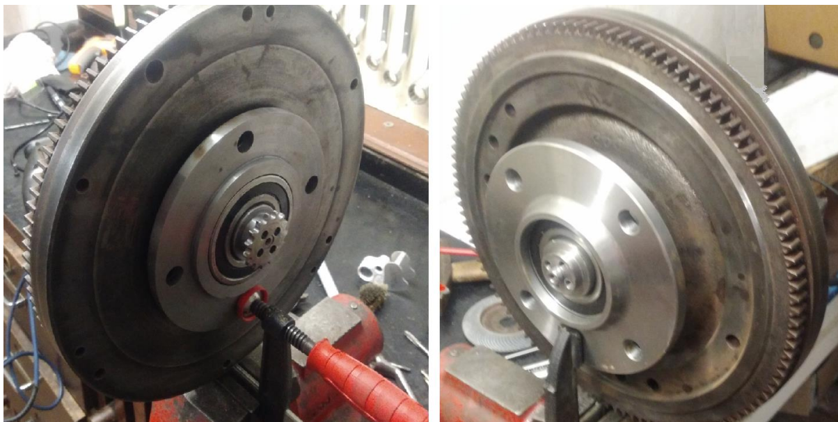
Obr. 32 - Stranové pohledy na spodní uložení (uložení setrvačniku)
