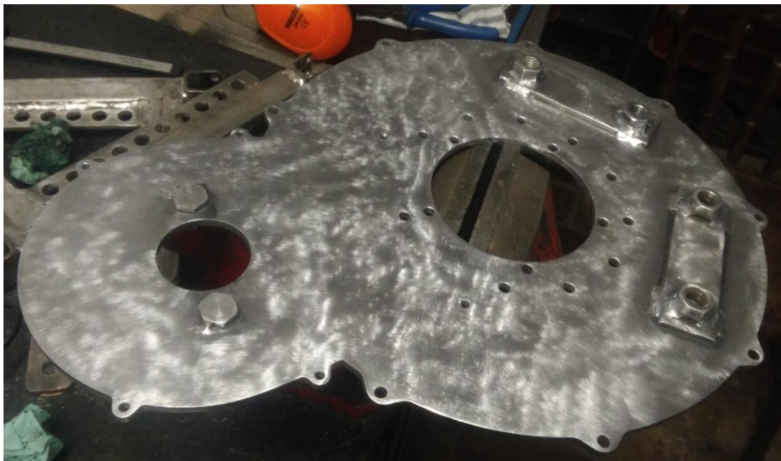
Obr. 36 - Deska ze strany řetězového převodu
