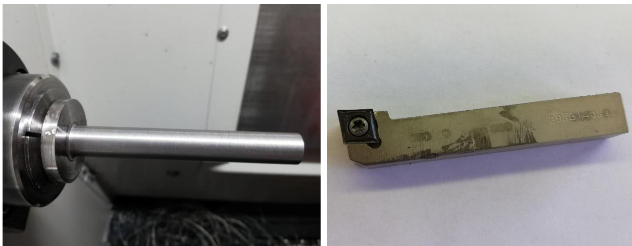
Obrázek 51: Polotovar a soustružnický nůž SCLCL 1212F-09 s VBD destičkou CCMT 09T304-SM
