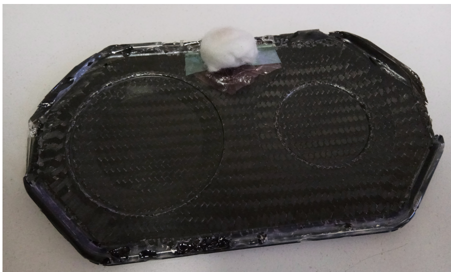
Obr. 57: Vylaminovaný polotovar pro disky sekundární sady
