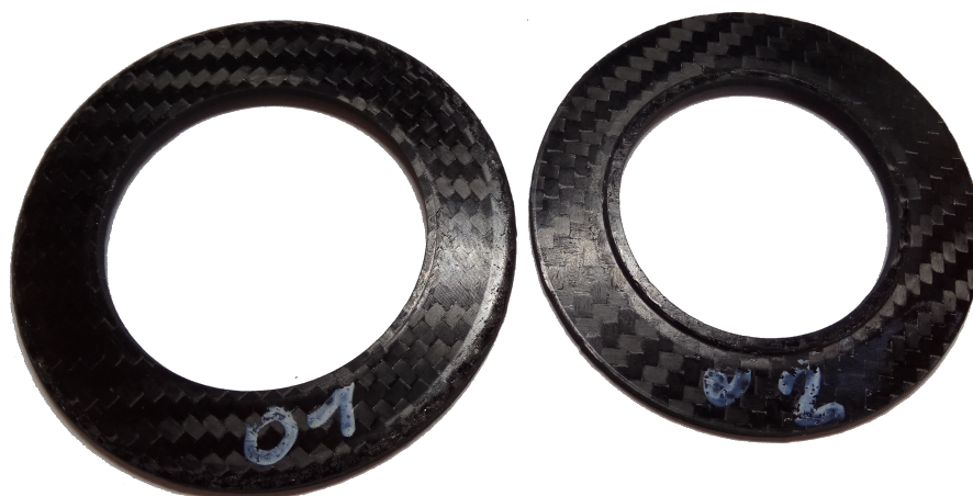
Obr. 62: Vyřezané disky sekundární sady
