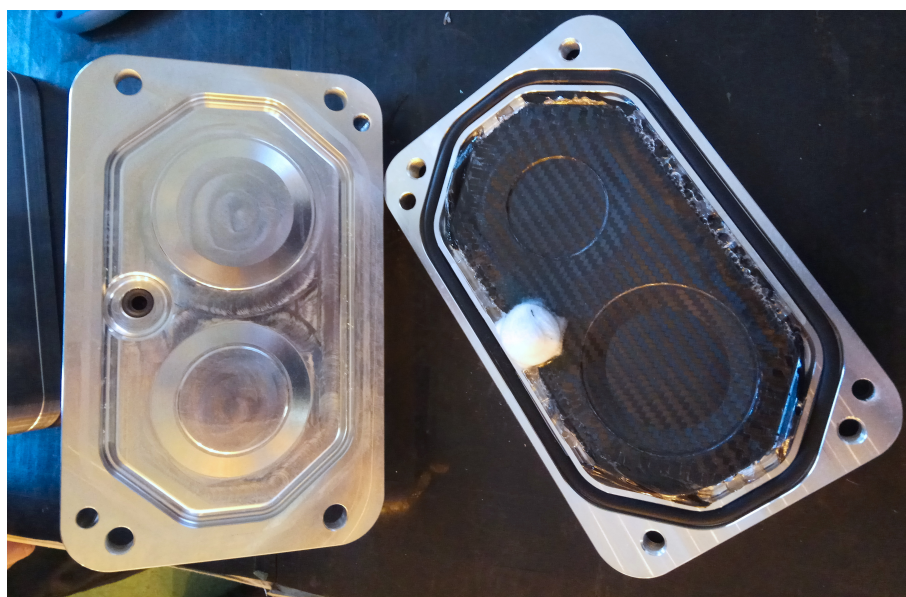
Obr. 55: Pohled na vytvrzený díl ve formě
