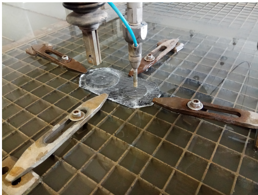
Obr. 60: Polotovar pro disky umístěný v řezacím stroji
