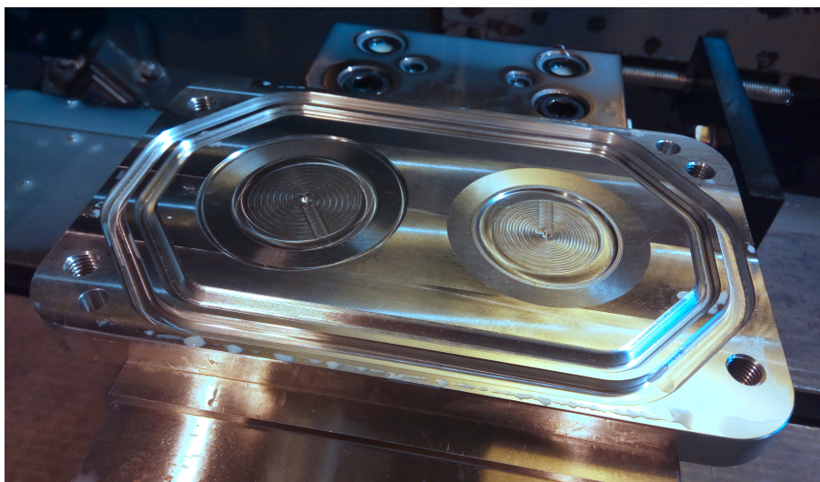
Obr. 44: Obrobená forma upnutá v obráběcím stroji
