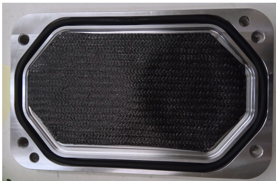
Obr. 52: Kladení jednotlivých vrstev prepregu
