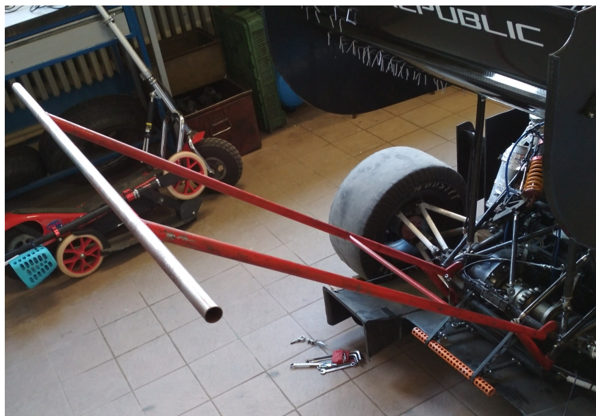
Obrázek 4: Současná tažně tlačná tyč
