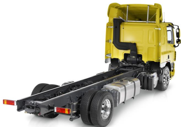
Obrázek 8: Rám podvozku silničního nákladního vozidla. Viditelné podélné nosníky [16]
