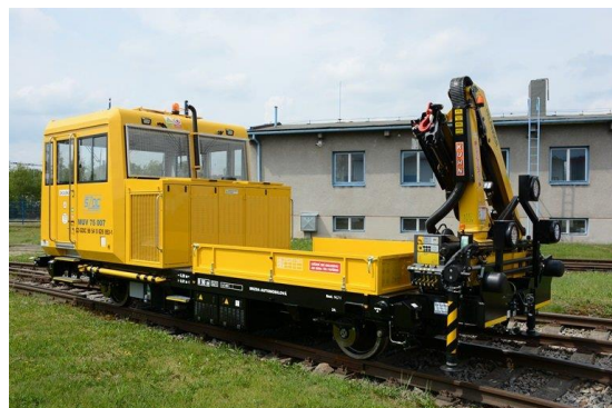
Obrázek 11: Vozidlo MUV 75 pro údržbu železničních tratí [13]
