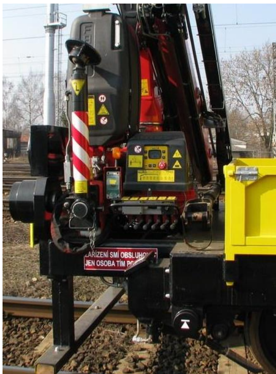
Obrázek 12: Prodloužený rám vozidla MUV [20]
