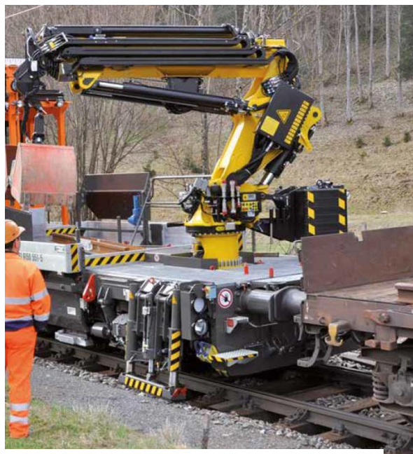
Obrázek 13: Uchycení jeřábu s otočným čepem zabudovaným do vozidla [19]
