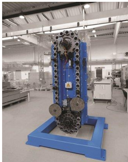
Obrázek 7: Zásobník pro automatickou výměnu nástrojů [5]
