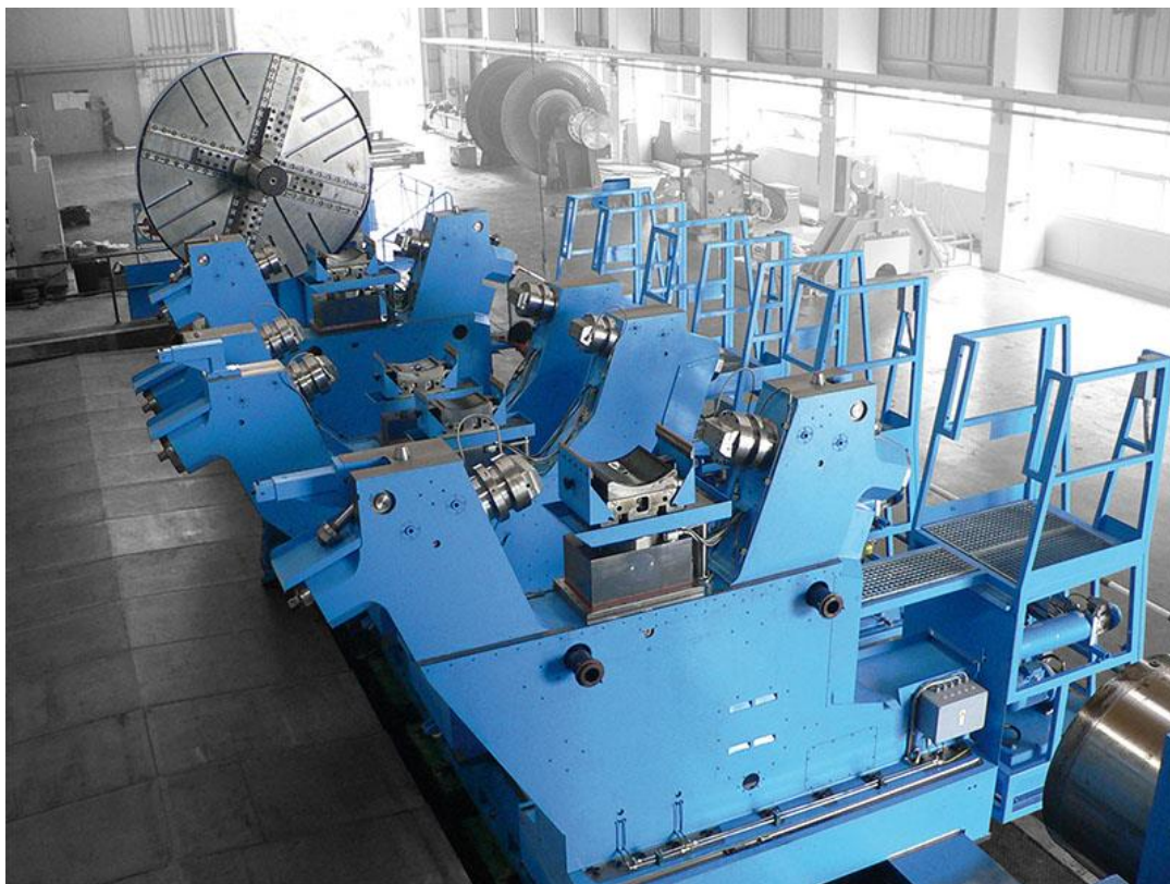
Obrázek 15 Otevřená opěra (Zdroj: https://www.skodamt.com )
