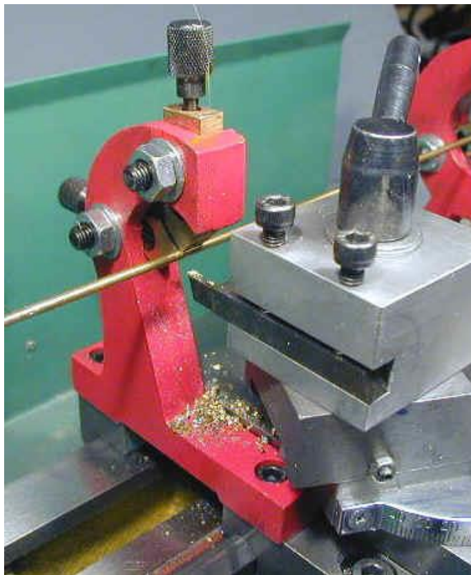
Obrázek 11 Malá unášivá opěra (Zdroj: http://www.mini-lathe.com )
