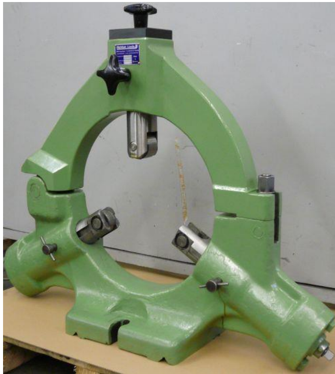
Obrázek 12 Zavřená opěra s odklopnou horní částí (Zdroj: https://www.luenetten.de )
