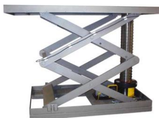
Obrázek 39. Zdvihací plošina Spirallift – skládání dvou pružných plechů do šroubovice [15]
