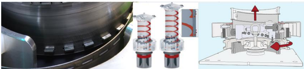
Obrázek 50. Technologie Spirallift od společnosti Gala Systems – princip [15]
