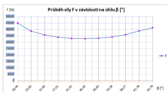
Graf.p. 3. Průběh síly F v závislosti na úhlu \beta
