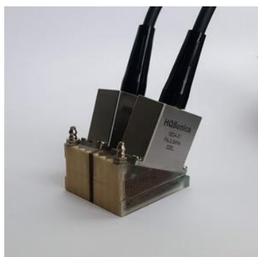
Obr. 35: Sonda HQ Sonics 13EM-01 s předsádkou HQS PA P68-1
