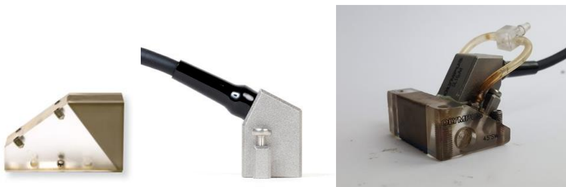
Obr. 34: Sonda Olympus 5L-16A1 s předsádkou SA1-N45S-IHC
