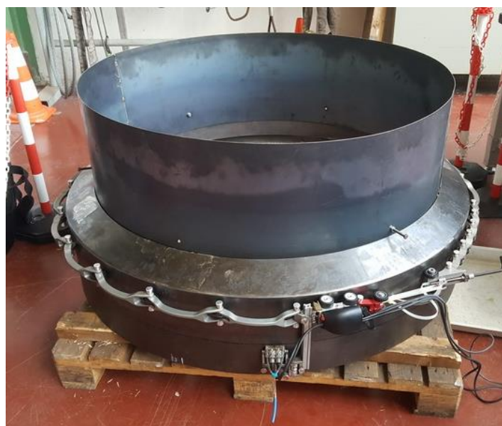
Obr. 39: Manipulátor ROTIX nasazený na zkušebním tělese se svarem 94, 95 kolektoru parogenerátoru
