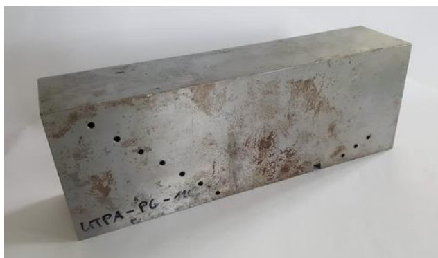
Obr. 37: Referenční měrka navržena pro zkoušení svaru kolektoru parogenerátoru
