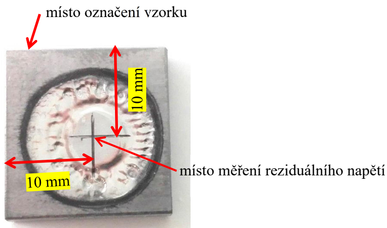
Obr. 24: Místo měření zbytkového napětí na leštěném vzorku
