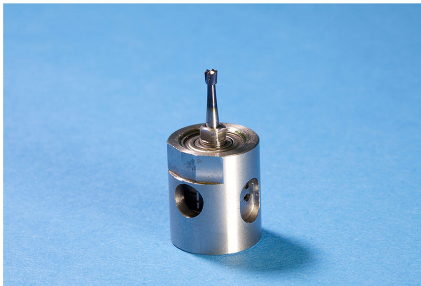
Obr. 16: Nástroj pro zhotovení otvoru u odvrtávací metody [12]
