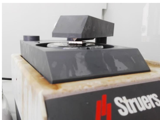
Obr. 26: Vzorek umístěný mezi elektrodou a plastovou maskou, pod kterou proudí elektrolyt
