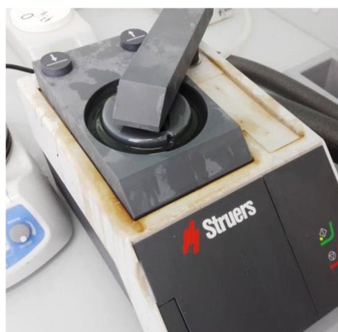
Obr. 25: Elektrolytické leštění Pomocí zařízení LectroPol
