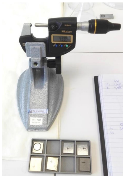
Obr. 28: Mikrometr pro měření hloubky úběru materiálu
