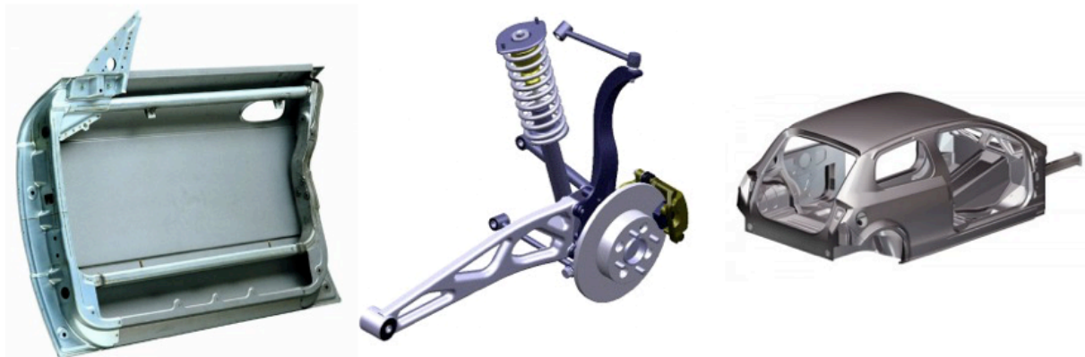
Obr. 3: Odlehčené komponenty vozidel - dveřní panel (vlevo), zavěšení (uprostřed), karoserie (vpravo) [7]
