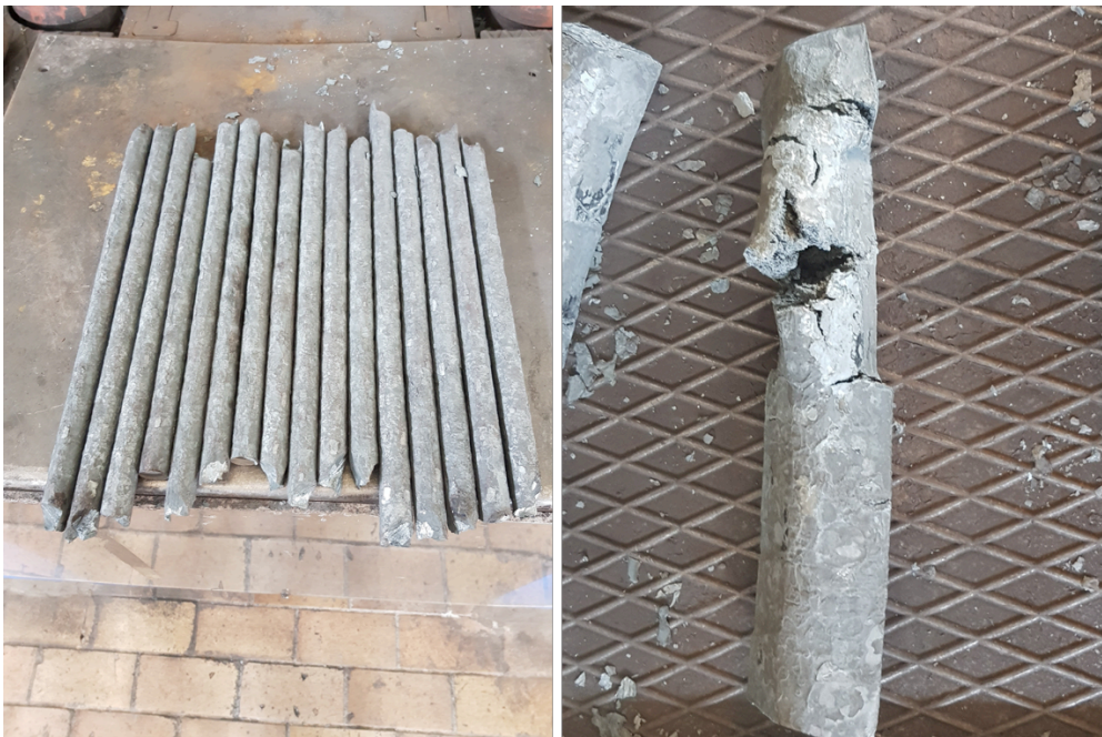
Obr. 25: Úspěšně překované tyče (vlevo) z experimentálního materiálu C3Mn2Al a popraskaný polotovar z materiálu C3Mn1,4Al
