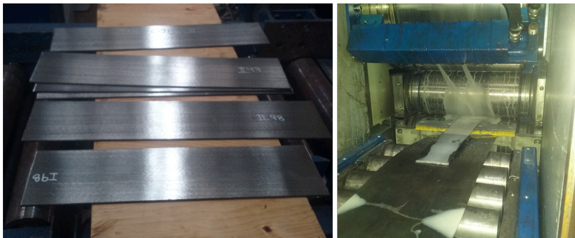
Obr. 30: Přebroušené vývalky (vlevo), válcování za studena (vpravo)
