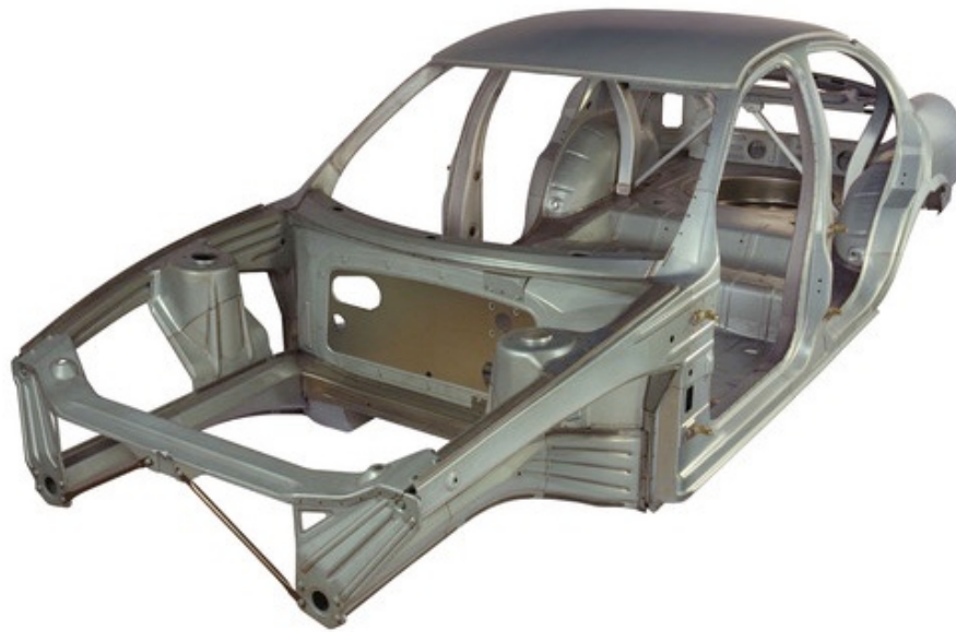
Obr. 2: Prototyp ultralehkého rámu vozidla ULSAB [7]
