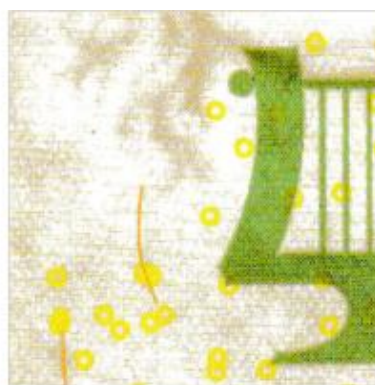
Obr. č. 2 – ochranná vlákna Zdroj : SURGA, Leopold. České bankovky a mince 1993-2012. Praha: Jerome, 2012. 44 s. ISBN 978-80-903266-8-2
