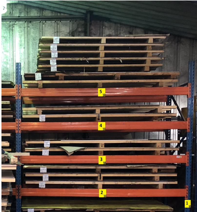
Obrázek 4-2: Vizualizace opozicování regálovými štítky na regálu č.1
