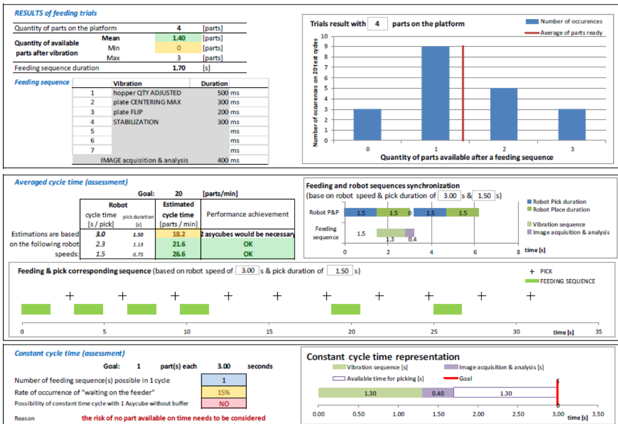
Obrázek 7-8: Výsledky testování velkých konektorů na Asycube 240
