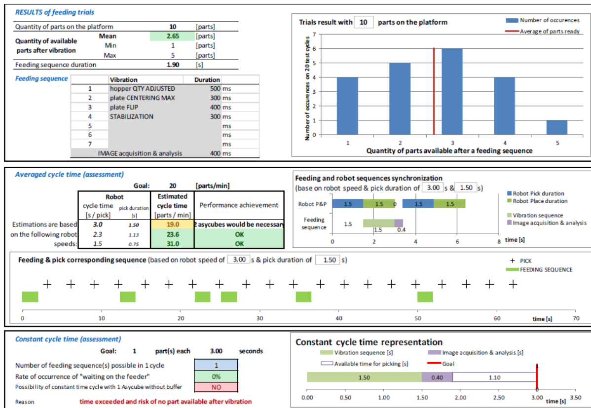
Obrázek 7-5: Výsledky testování malých konektorů na Asycube 240
