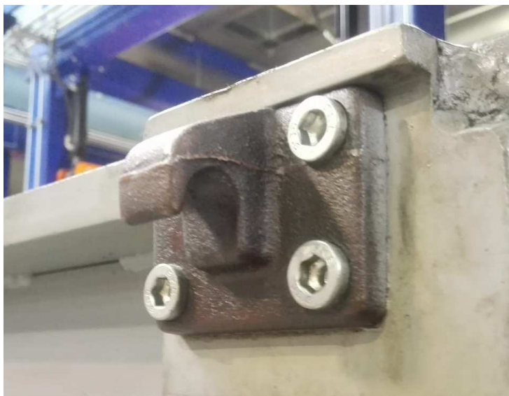
Obrázek 34 - Háčky na upnutí formy do lisu [23]
