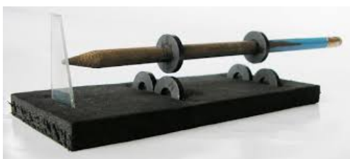
Obrázek 1.9: Stabilizace opěrem v horizontálním směru
