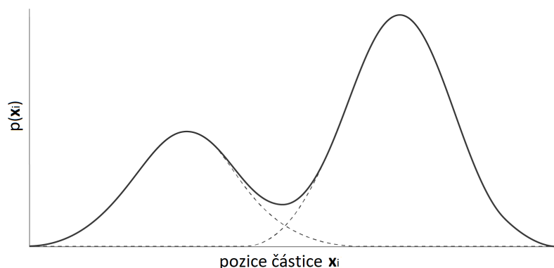
Obrázek 3.2: Příklad multimodálního (v tomto případě bimodálního) rozložení pravděpodobnosti
