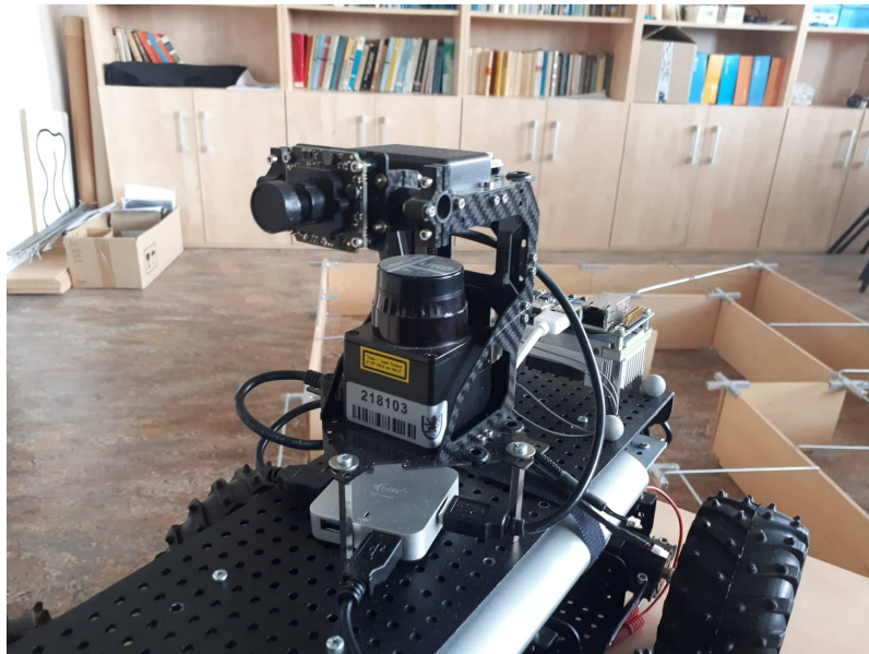
Obrázek 5.6: Příklad sestavy kamera-LiDAR.
