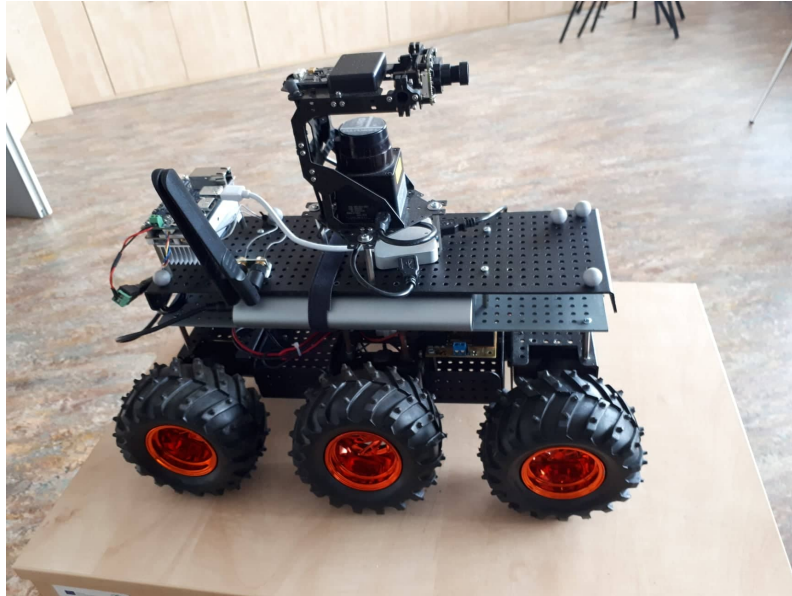
Obrázek 4.2: Dagu Wild Thumper 6WD s připevněnými senzory
