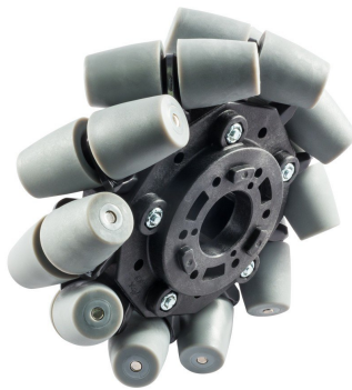
Obrázek 4.1: Kolo všesměrového robota
