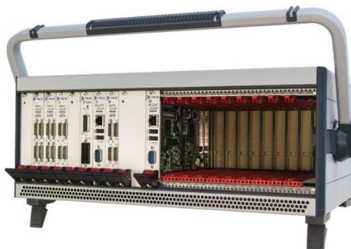
Obrázek 52: REMCS – 19“rack systém pro 19 karet [22]
